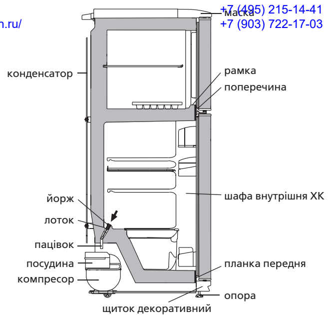
Рисунок 4 – Схема зливу талої води із ХК
